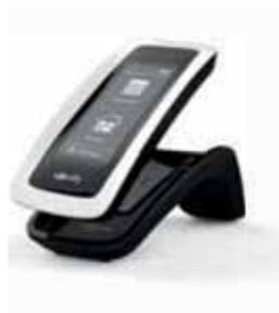
Funkhandsender Nina™ io: Touch-Display für manuelle Bedienung sowie Bedienung erstellter Szenarien in Räumen, Gruppen, Etagen und dem kompletten Haus.
