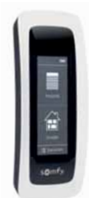
Funkhandsender Nina™ io: Touch-Display für manuelle Bedienung sowie Bedienung erstellter Szenarien in Räumen, Gruppen, Etagen und dem kompletten Haus.
